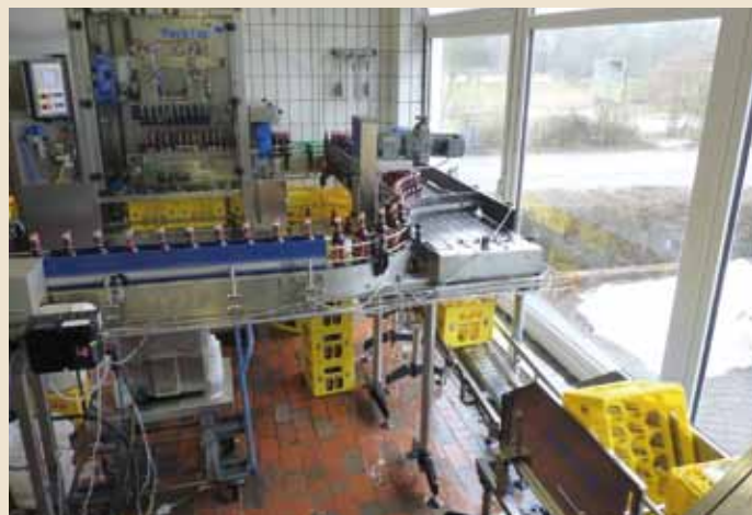
Die enge Kastenführung am Kastenwender (vorne re.) sorgt für ein geregeltes und zuverlässiges Fallen
